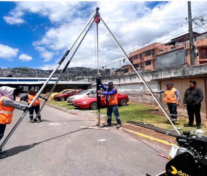
El trípode está fabricado con secciones de aluminio que lo hacen fácil de transportar, instalar y de alta resistencia.
